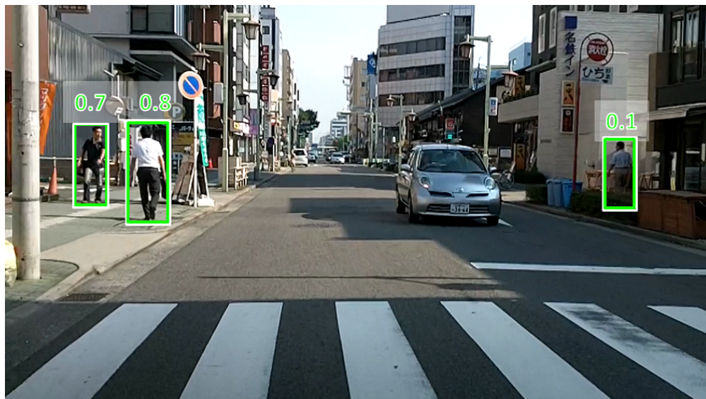
歩行者の見つけやすさの例（数値は見つけやすさの推定値）。 各歩行者の見つけやすさはドライバ毎に異なると考えられる。
