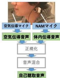
図1：自己聴取音声生成処理
